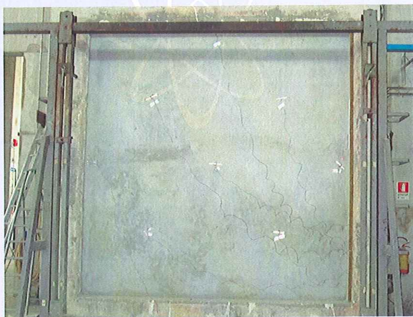
Fotografia della faccia non esposta al fuoco del campione prima della prova.
